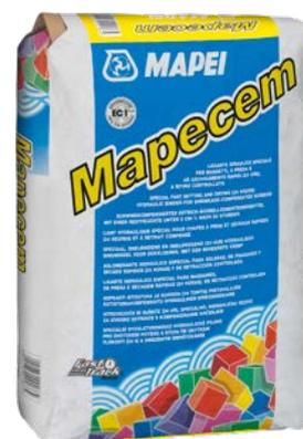
**Technische Daten:****Mischungsverhältnis:**350–450 kg Mapecem mit 1 m<sup>3</sup> Zuschlag (0–8 mm)**Anmachwasser:** W/Z-Wert 0,4**Mischzeit:** 3–4 Minuten**Verarbeitungszeit:** ca. 20–30 Minuten**Wartezeit vor der Verlegung:** ca. 4 Stunden bei keramischen Fliesen**Restfeuchte:** nach 24 Stunden < 2 CM-%**Einbringung:** manuell oder mit Fördertechnik**GISCODE:** ZP1**EMICODE®:** EC1 Plus**Verbrauch:** ca. 3,5–4,5 kg/m<sup>2</sup>/cm**Lagerung:** 12 Monate
