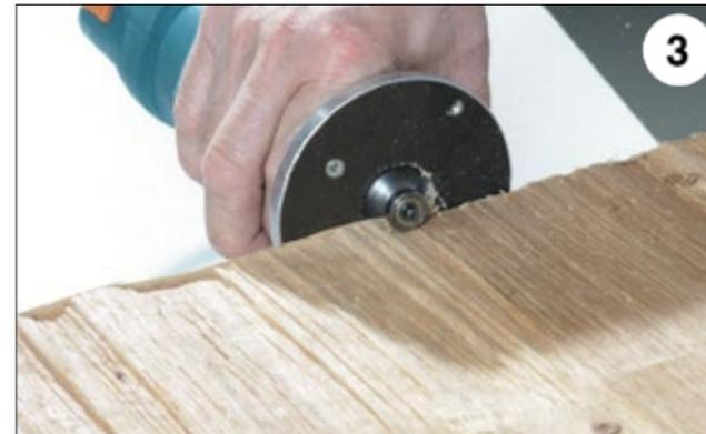
Fahren Sie mit dem Profilfräser möglichst waagrecht entlang der Kante und säubern das überschüssige Kantenmaterial.
