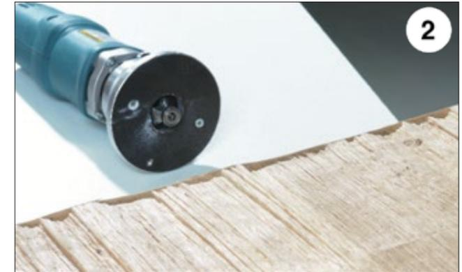
Überstände mit Profilfräser nacharbeiten. Es ist notwendig einen Anlauring zur sauberen Führung zu montieren.
