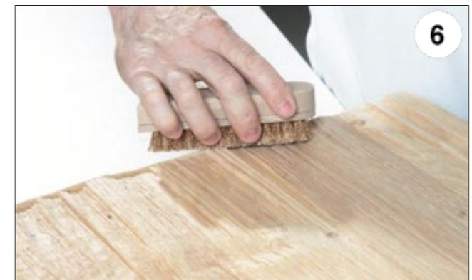
Struktur anschließend mit einer feinen Kupferdrahtbürste in Strukturrichtung säubern.
